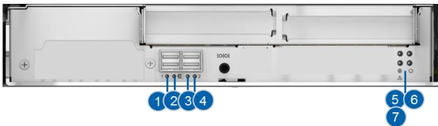
图 3-22 2U 和 3U IO 模块指示灯
