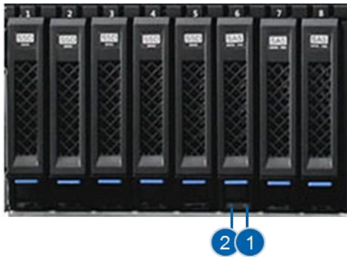
图 2-15 2U25 机柜硬盘指示灯
