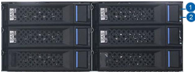
图 2-14 2U12 机柜硬盘指示灯
