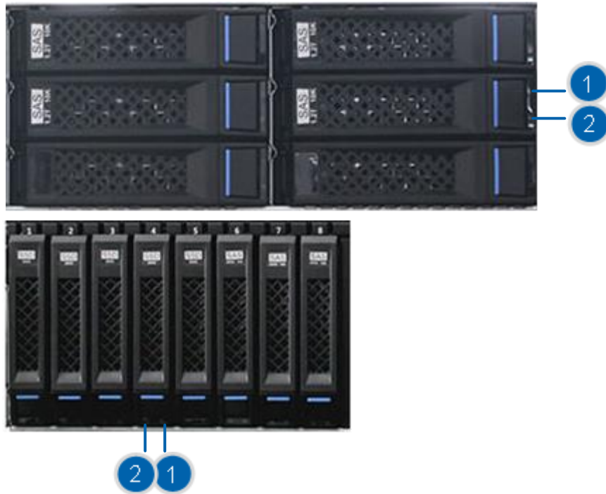
图 3-17 机柜硬盘指示灯
