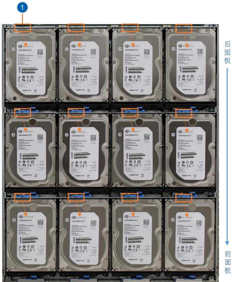
图 2-16 3U 机柜抽屉内硬盘指示灯
